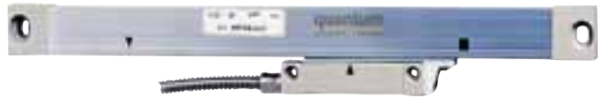
Quantum. Système de mesure par règle de verre très haute précision. Guidage sur micro roulements assurant une haute résolution connecté avec un pied de montage par un raccordement. Une protection en caoutchouc contre la projection de liquide et de la poussière et éclaboussure. Un flexible en acier protège le câble sur 3 mètres. Adapté pour DPA2000/DPA2000S. Sans montage.
