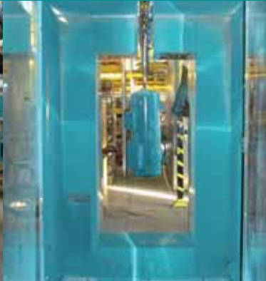
Bei 180°C erhalten AIRCRAFT® Kompressoren ihre hochwertige Oberfläche.
