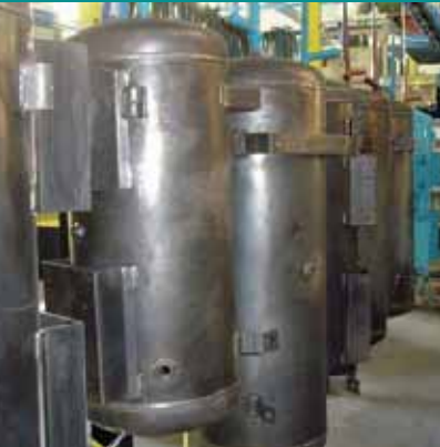
Vorbereite Kessel laufen in die eigene, umweltfreundliche Pulverbeschichtungsanlage
